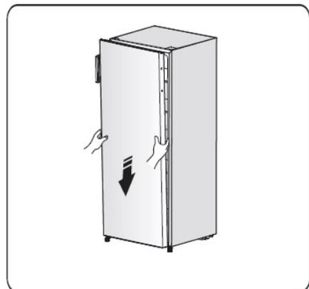
9. Trasferire la parte superiore della cerniera e allineare l'asse della cerniera nel foro superiore della porta, e regolare la posizione della porta (si prega di sostenere la porta con la mano durante il processo), fissare la cerniera superiore con le viti autofilettanti.
