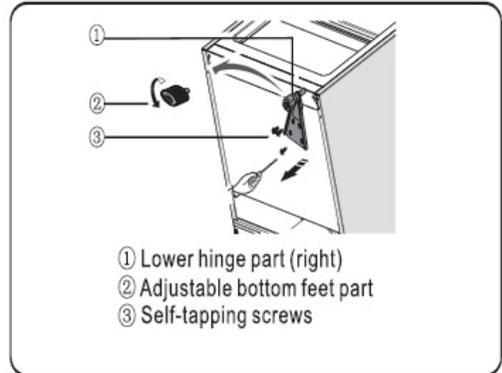
7. Sostituire la cerniera inferiore sul lato sinistro e fissare con le viti autofilettanti. Sostituire i piedini regolabili su un altro lato e fissarli.
