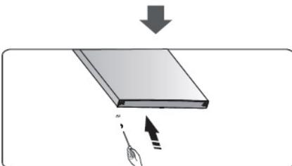
6. Poggiare il congelatore sulla schiuma morbida dell'imballo o un materiale simile. Rimuovere entrambi i piedini regolabili, la cerniera inferiore svitando le viti autofilettanti della flangia.
