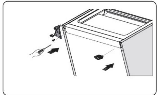
8. Trasferire la porta nella posizione corretta, regolare la cerniera inferiore; rendere l'asse della cerniera ed il foro inferiore della porta inferiore allineati
