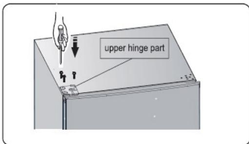
10. Installare il coperchio del foro della vite nell'angolo in alto a destra del congelatore. Installare il coperchio della cerniera superiore (che si trova nel sacchetto di plastica) nell'angolo sinistro. Inserire l'altro coperchio della cerniera superiore nel sacchetto di plastica.
