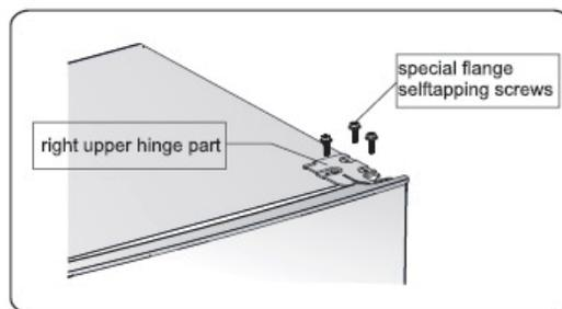
3. Rimuovere l'asse della cerniera superiore, trasferirlo sull'altro lato e fissarlo saldamente, quindi riporlo in un posto sicuro.
