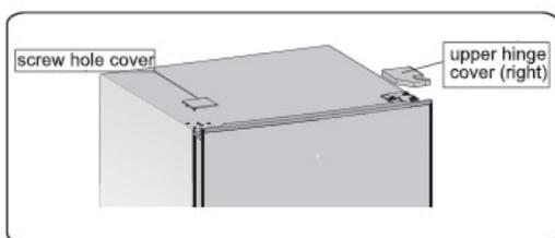
2. Svitare le viti autofilettanti della flangia che servono per fissare la parte superiore della cerniera destra con una chiave tubolare o una chiave da 8 mm (sostenere la porta superiore con la mano quando si esegue).
